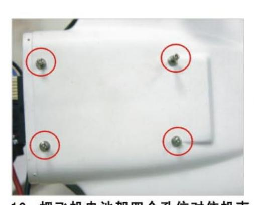
10. 把飞机电池架四个孔位对住机壳 11. 四个孔位〈注意: 先用手钻把机 壳四个孔位钻大到2mm〉
