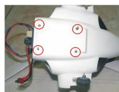
用十字螺丝套上介子装进电池架, 12. 把接收机天线从机壳后面孔位 再用螺母锁紧螺丝(螺丝: 2\*25, 拉出来绕在平尾上
