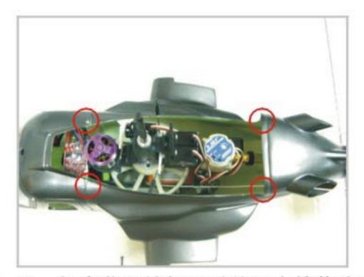
20. 把机壳盖子装上,用自攻螺丝锁 21. 机壳盖子锁好以后就把主转旋头装上锁住。
