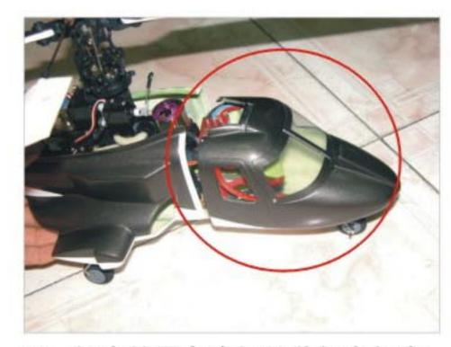
14. 把座舱用自攻螺丝装好在机壳 头罩上,然后把机壳头罩套上 (螺丝: 1.4\*5,4个)
