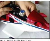
将主机架和尾管连接。
