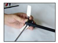
将尾箱拆下, 拉杆取下。
